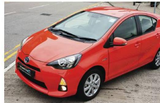
La Toyota Prius, une voiture hybride, est dotée d'un coefficient de résistance  $C_R = 0,26$ , l'un des plus bas pour les véhicules automobiles de série.
