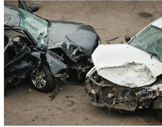
Dans cette collision inélastique, une grande partie de l'énergie a servi à déformer de façon permanente les voitures qui sont entrées en collision.
