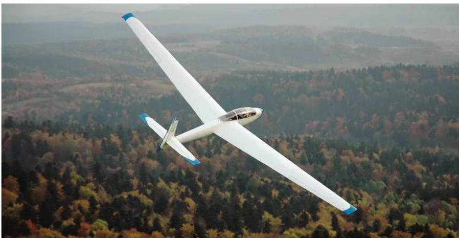
Un planeur peut prendre de l'altitude en pénétrant dans un courant ascendant d'air chaud appelé « courant thermique ».
