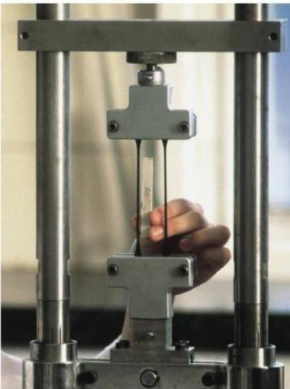
Ce sont des instruments comme celui-ci qui permettent d'obtenir des graphes tel celui de la figure 14.2 en imposant une déformation à un matériau tout en mesurant la force requise pour la produire.
