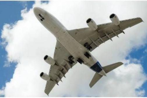
Les quatre moteurs du A380 de Airbus sont capables de générer une force de 1244 kN, nécessaire pour amener en peu de temps les 560 000 kg de cet avion à une vitesse permettant son décollage.
