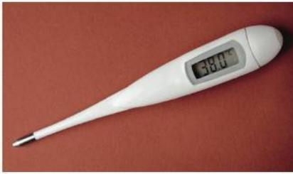
Les thermomètres électroniques à affichage numérique permettent une mesure plus rapide et plus commode.
