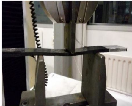
FIGURE 2.19 – Flexion 3 points sur un échantillon de carbone-époxy
